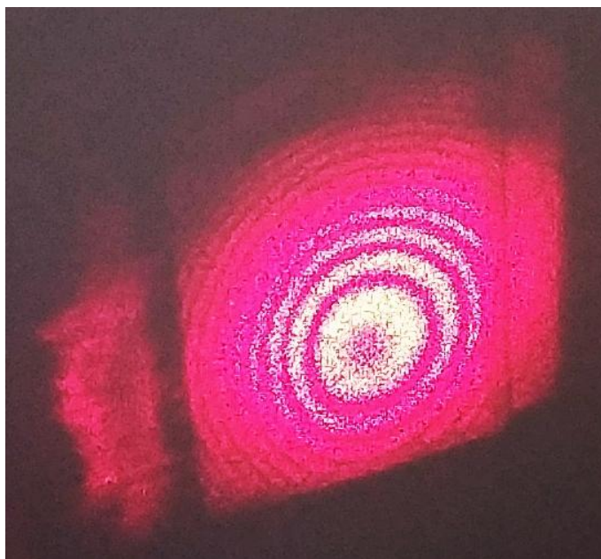
Rys. 3. Obraz uzyskiwany w interferometrze Michelsona przy użyciu światła laserowego
