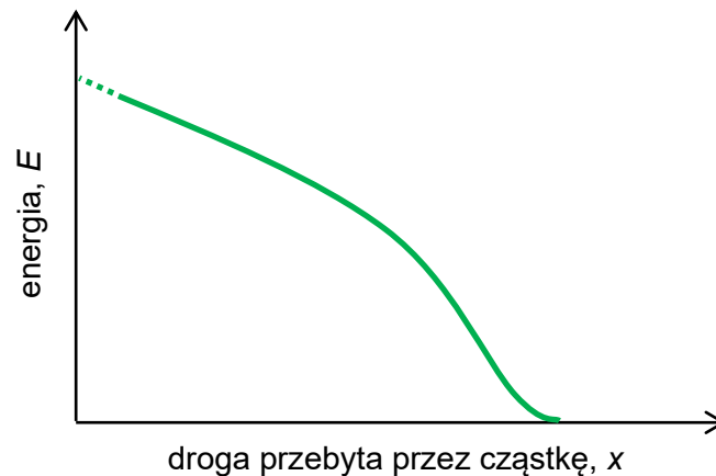
Rys. 5. Zależność energii cząstek \alpha od przebytej drogi
